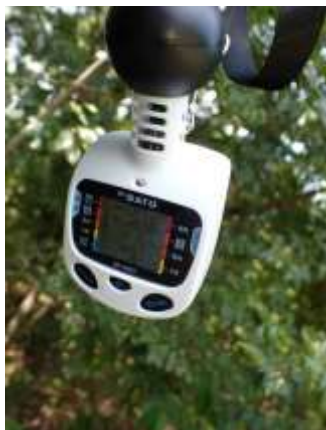
熱中症予防のための暑熱指標計 危険レベルになるとアラームが鳴る設定
