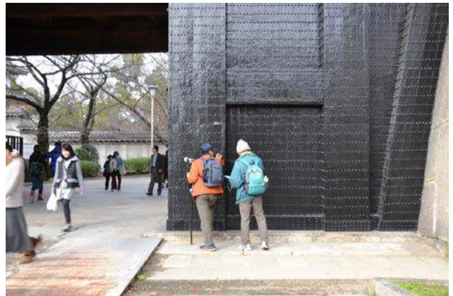
多聞櫓黒塗り鉄扉の表面温度を測定中 日なたと日かげで大きく違った。 151213 撮影 柘元慶子
